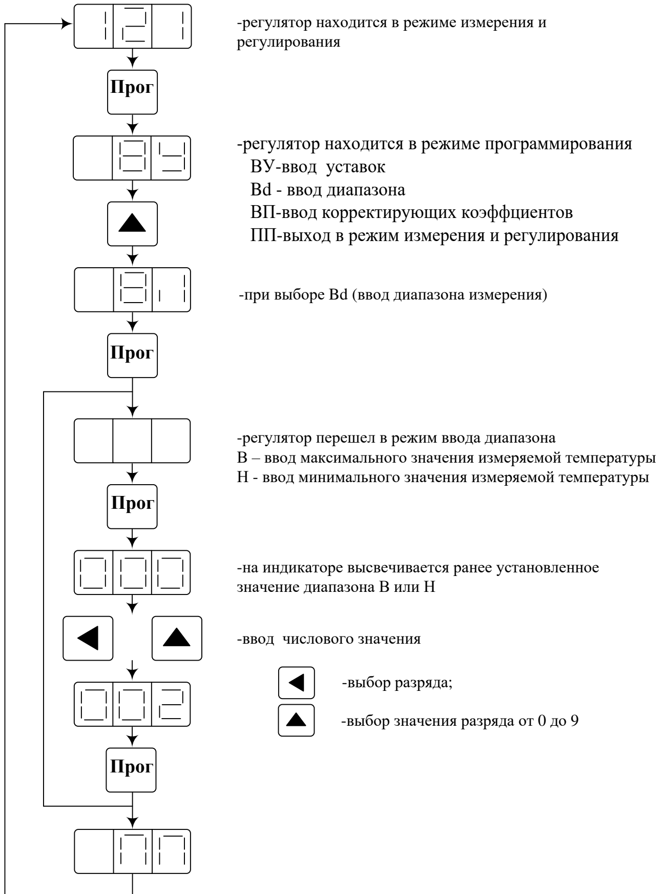
Рисунок 11 – Алгоритм работы регулятора в режиме ввода диапазона измерения
